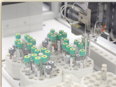
自動系統的機械臂會把樣本試管逐一放置輸送帶上，減輕人手負擔。
