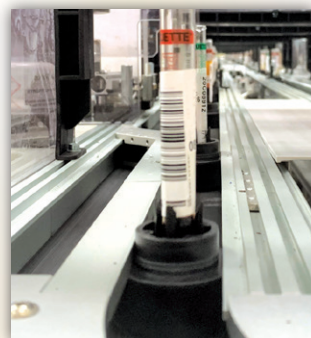
輸送帶上附有一個個「水泡」，負責運送試管到不同儀器進行分析和化驗。
