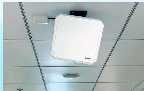
射頻識別臨床樣本追蹤系統 RFID Specimen Tracking System，有效追蹤樣本位置及防止樣本丟失。
