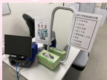
PORTACOUNT Machine 於疫情中添置的新型口罩測試機
