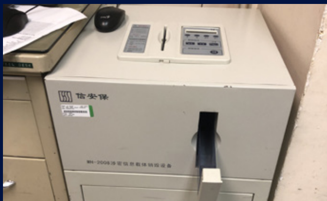
消磁機，所有報廢電腦硬碟都必須經過消磁程序，清除硬碟上資料，確保資訊安全
